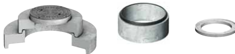
Schachtopbouw T2 versie met Ø1000mm schachtringen (incl. DS-SDV seal) en nivelleringsringen. Een standaard afscheider met Artikelnummer OLE.06.1800D wordt dan OLC.06.1800D-T2.
