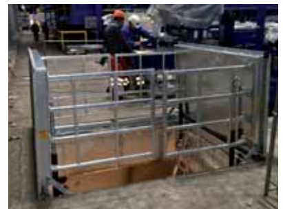
Hydraulische schachtafdekking als montage-opening met invalbeveiliging.
