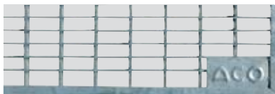
maasrooster, maaswijdte 30 x 10 mm, beloopbaar tot 1,5 kN, berijdbaar, wieldruk tot 9 kN.
