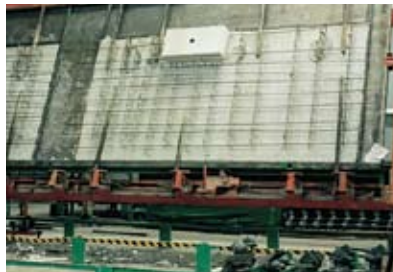
De montageplaat aan de buitenkant blijft tijdens het draaien resp. het transport van de wand vast in het kozijn zitten.
