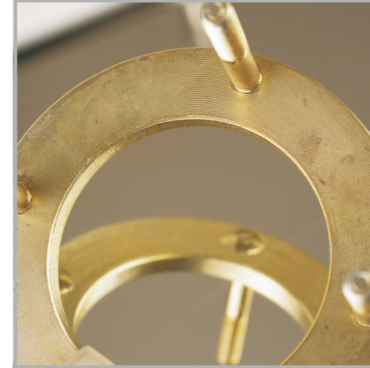
Bouten met draad in de flens bevestigd en vastgelast. Deze bouten hebben een hoge trekvastheid.
