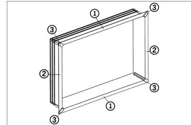
3. Nach dem Zusammenstecken der Anschlussprofile ① + ② und der Eckverbinder ③ ist die Dichtung aus dem Therm Leibungskellerfenster zu entfernen.
