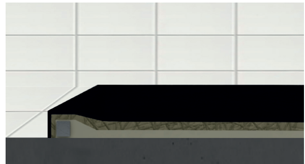
2. opbouw op de badkamervloer
